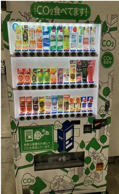
CO<sub>2</sub> を食べる自販機とはその名の通り CO<sub>2</sub> を吸収する自販機です。自販機の中には空気中の CO<sub>2</sub> だけを吸収する特殊材が入っており、木のような役割を果たしています。この吸収材の吸収量は杉の木 20 本分にも及ぶそうです。沢山の CO<sub>2</sub> を吸収した吸収材はタイルにしたり、肥料にして野菜を育てたりしています。この肥料を使うことによって畑の土地が痩せることを防ぎ、毎年安定して野菜を収穫できるようになります。これは CO<sub>2</sub> を削減することに繋がります。
